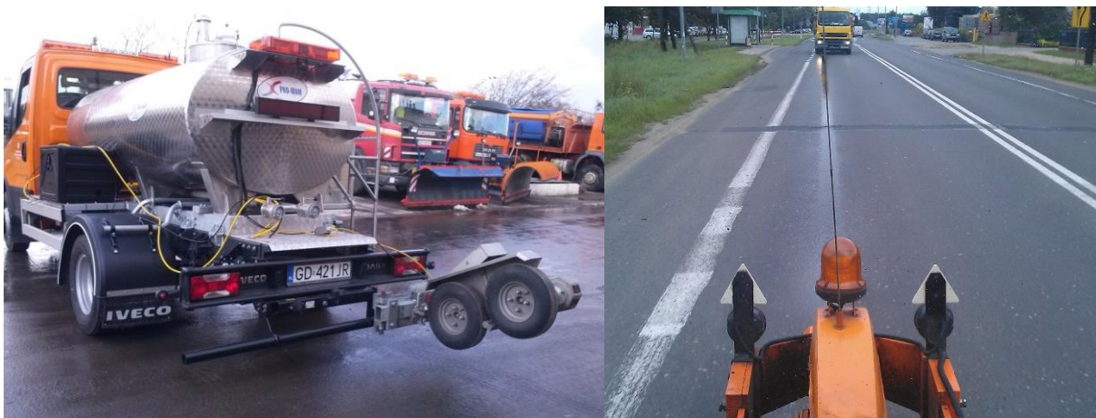
Fotografia 2.a) Zestaw pomiarowy TWO – widok z tyłu; b) pomiar współczynnika tarcia nawierzchni wykonywany w prawym śladzie kół
