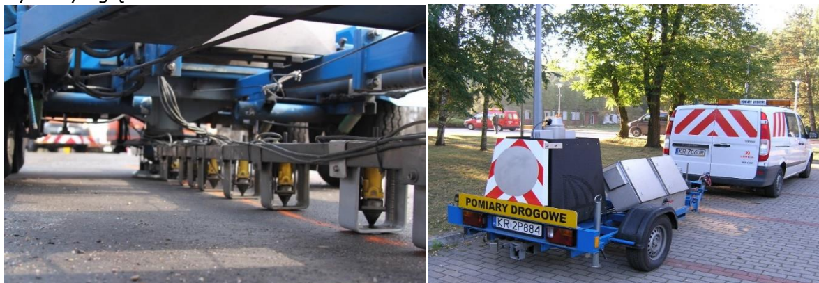
Fotografia 1. a) Geofony pomiarowe oraz płyta naciskowa w urządzeniu; b) zestaw pomiarowy FWD
